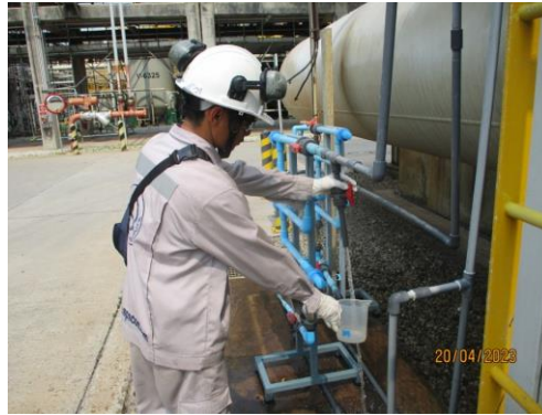
ภาพที่ 3.2.8-1 การเก็บตัวอย่างน้ำระบายทิ้ง จากระบบผลิตน้ำหล่อเย็น (Cooling Tower)
